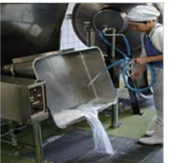
使用済みの廃液で排水溝の洗浄
